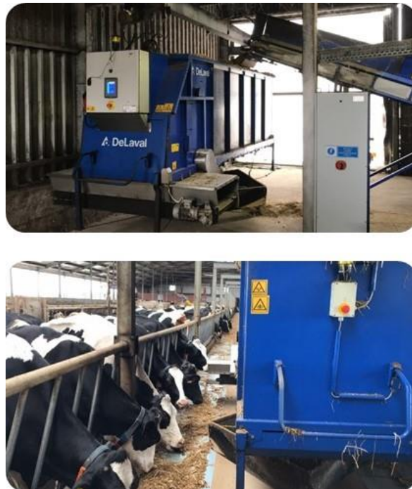
3. ábra: Felsőpályás takarmánykiosztó robot (Forrás: Húth és Tóth, 2021; Digitális Agrárakadémia)
